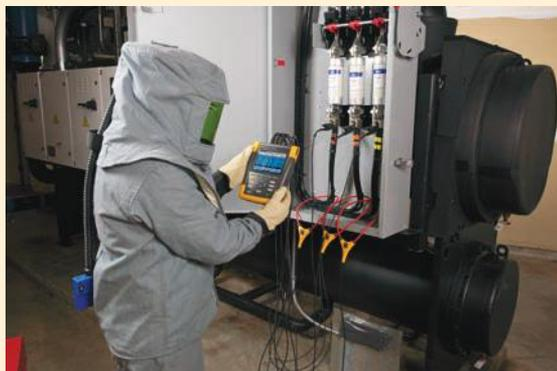
Solo tiene que conectar los cables de medida de tensión y las sondas de corriente flexibles al suministro del motor.
