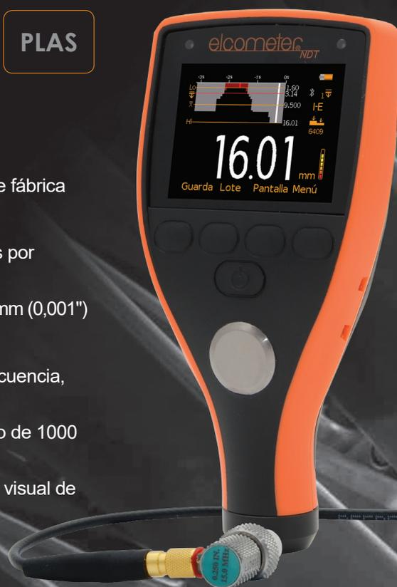
El modelo PTG8 es el medidor más alto de la gama y dispone de todas las funciones y la funcionalidad necesarias para medir con precisión el espesor de prácticamente cualquier material.
