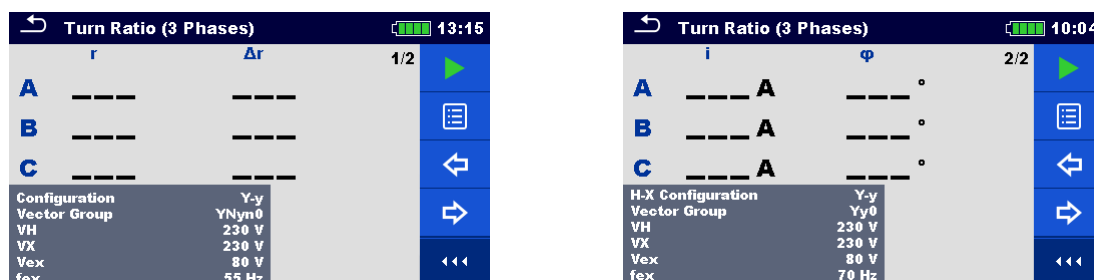
Figura 11.14: Menú de medición de transformador trifásico: ratio d espira (izquierda), corriente de excitación y desviación de fase (derecha)
