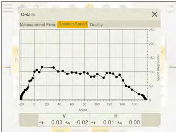
Este gráfico muestra la velocidad de rotación de las unidades de medición durante la medición. Es la base para el número de calidad "Velocidad y uniformidad".
