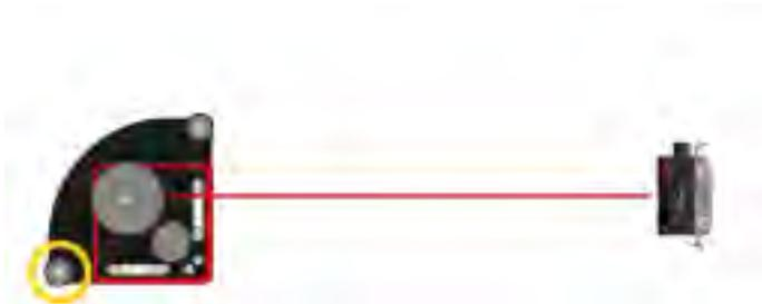
*Divida el valor por dos y ajuste a 0,00 con este tornillo de nivelación.*
