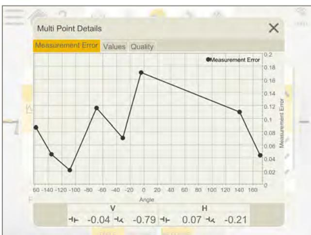
El gráfico muestra el error de cada medición comparado con la medición total. El error de cada punto de medición es su desviación respecto a la medición total. Se muestra en desviación y ángulo.
