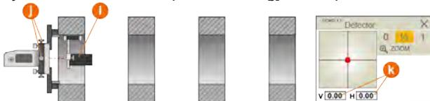
11. Mueva el detector a la posición de centrado de diámetros interiores de ajuste número 2 [l]. Incline el haz láser al valor **0** utilizando los tornillos de ajuste del micrómetro [m].
