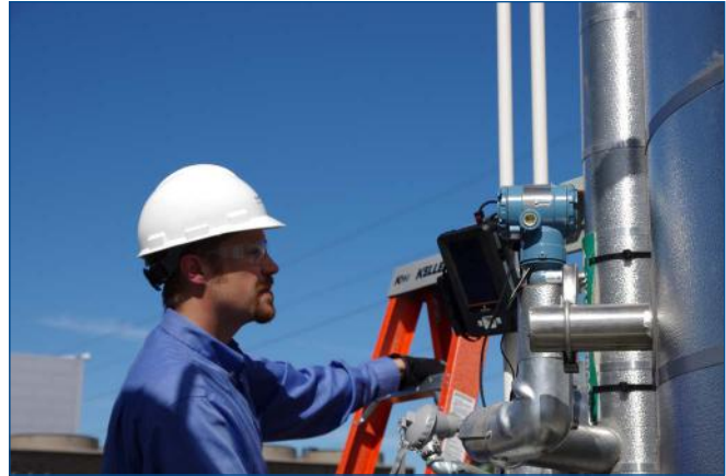
El accesorio magnético de suspensión permite que usted fije la unidad Trex a una tubería, liberando sus manos para otro trabajo.
