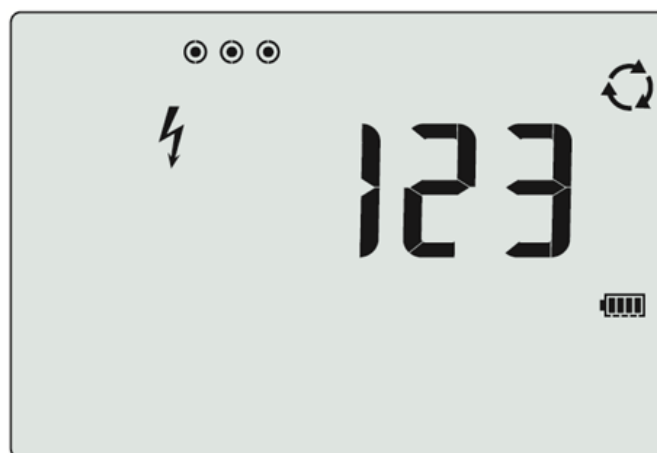
Imagen 13 - Demostración de comprobación de Rotación de Fases.
