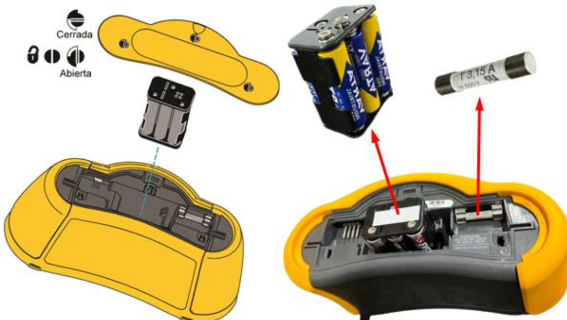
Imagen 18 - Compartimiento de Baterías y Fusible.
