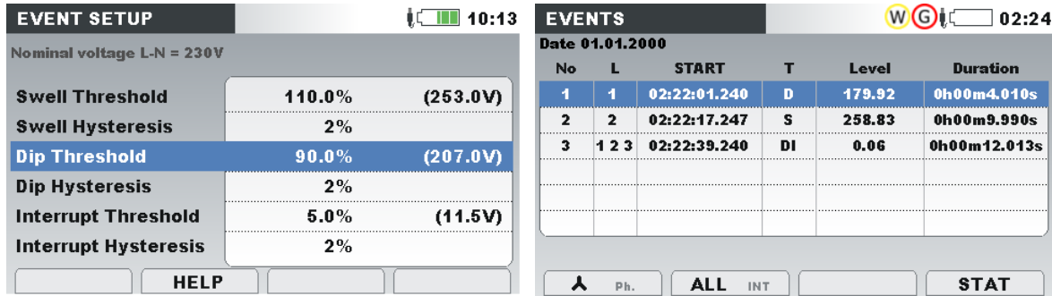
Figure 5.11: Pantallas relacionadas con las caídas de tensión en el instrumento
