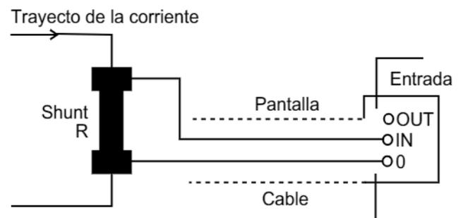
Para intensidades entre 0 - 10 A, es apropiado un shunt de 100 mΩ. Para intensidades entre 10 - 25 A, es apropiado un shunt de 10 mΩ. Recuerde que la tensión en el shunt no debe superar los 4 V.
