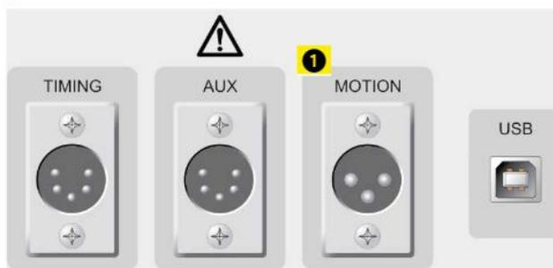
1. XLR3: canal de entrada analógico opcional, pensado para medir el desplazamiento o cualquier otra magnitud analógica.
