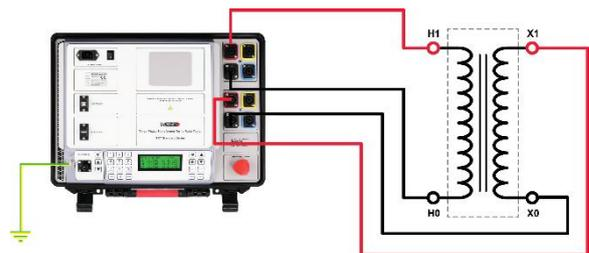
Conexión de TRT a transformador monofásico
