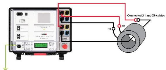
Conexión de TRT a un transformador de corriente amontado
