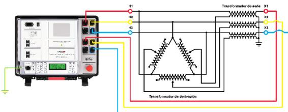
Conexión de TRT a transformador desfasador
