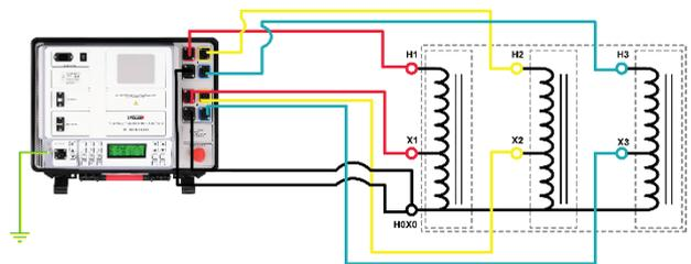
Conexión de TRT a autotransformador trifásico
