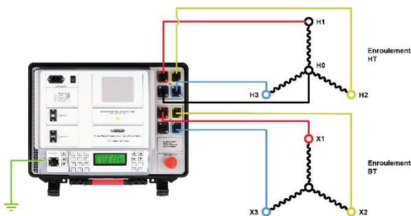
Conexión de TRT a transformador trifásico
