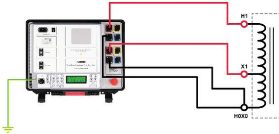
Conexión de TRT a autotransformador monofásico
