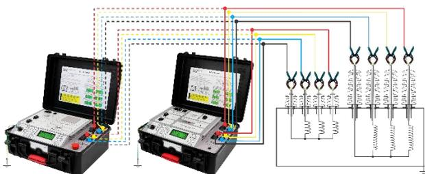
*Conexión de TRT Standard y TWA Standard a un transformador*
