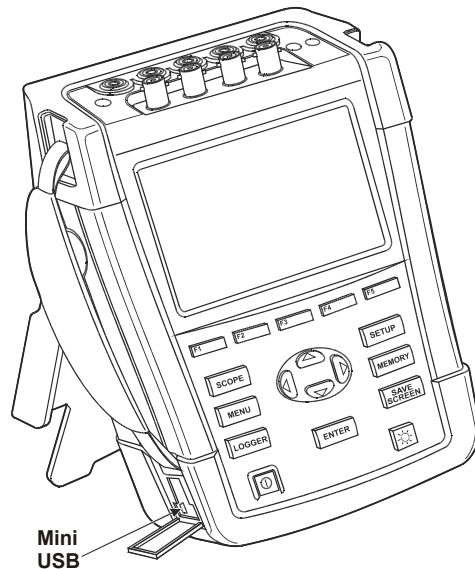
Figura 25-1. Ubicación del conector de interfaz USB
