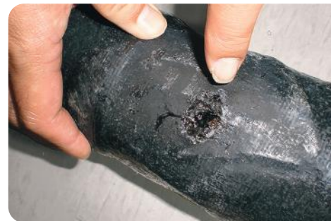
Averías en cables con aislamiento de papel impregnado
