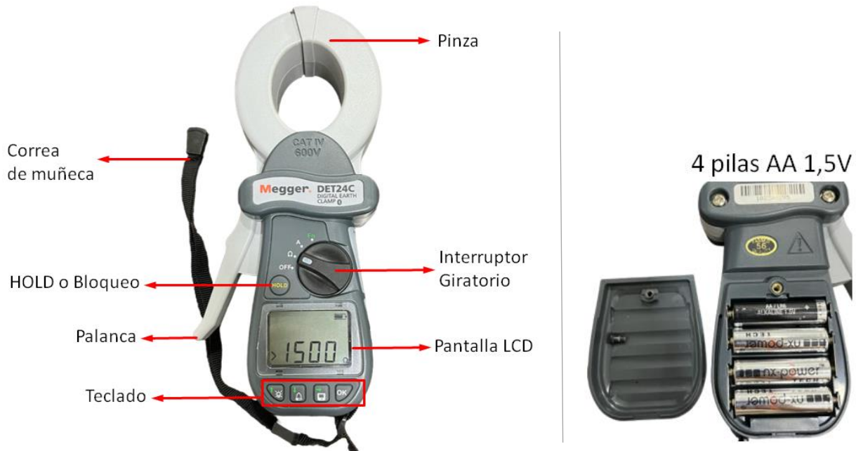
Imagen 1 -Display de la Pinza Comprobadora de Resistencia de Tierra DET24C - Megger.
