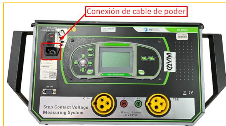
Imagen 13 – Conexión de la alimentación del instrumento a través de cable de poder.
