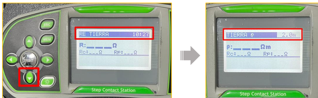
Imagen 10 - Procedimiento para medición en Resistividad del suelo.
