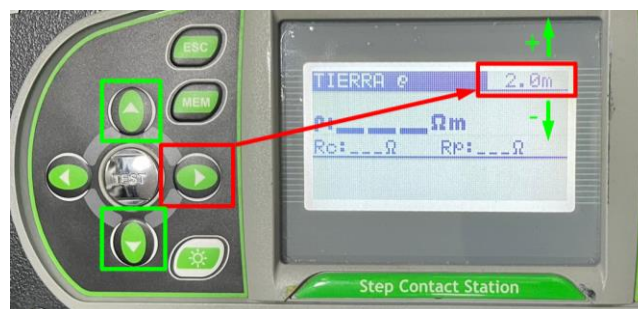
Imagen 11 - Modificación de parámetro distancia "a" entre las picas.
