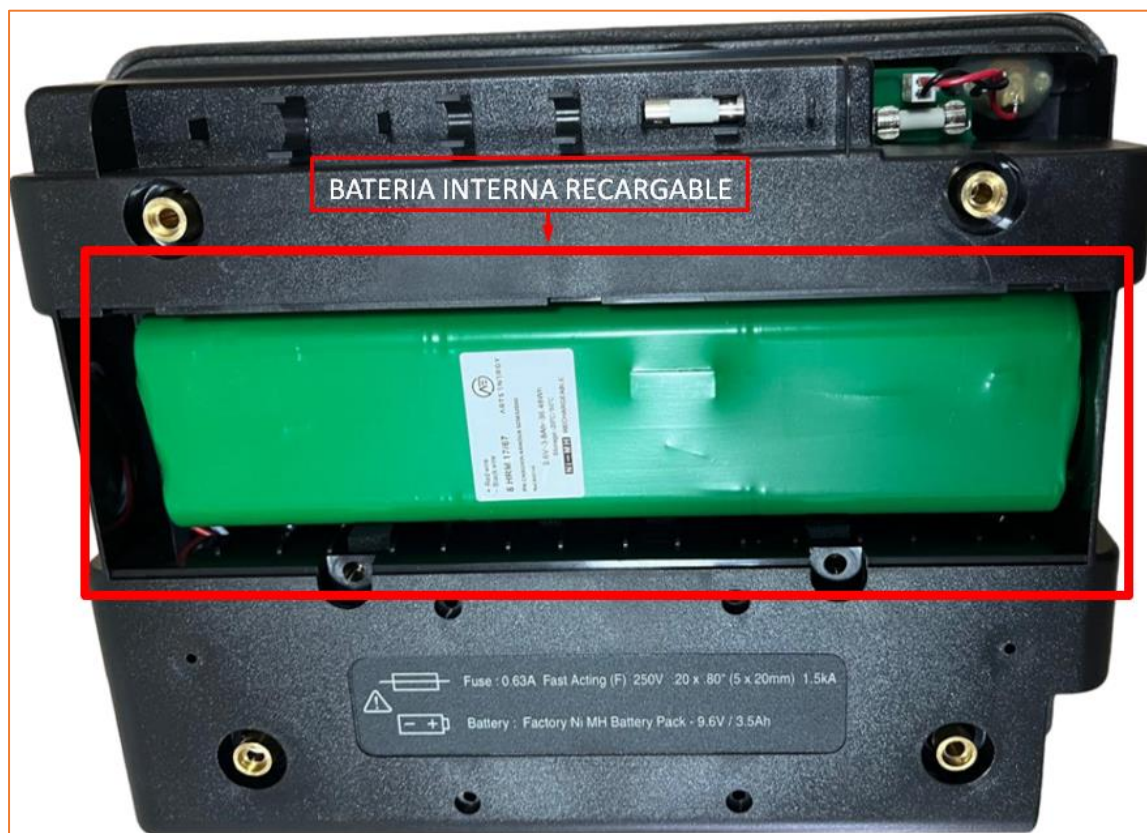
Imagen 22 - Compartimiento de la batería del instrumento.
