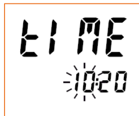
Imagen 15 - Presionando la tecla "Hz/Options", aparece el ajuste de Hora.
