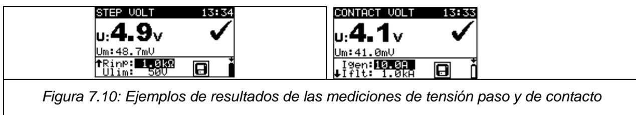
Figura 7.10: Ejemplos de resultados de las mediciones de tensión paso y de contacto
