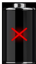
Figura 1.7: Indicación de fallo de batería (carga suspendida, fallo en el temporizador, falta la batería)
