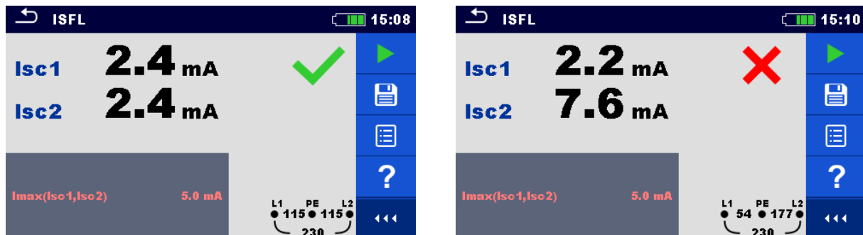
Figura 7.90: Ejemplos de mediciones de primera corriente de fuga de fallo
