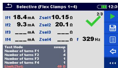
Figura 11.28: Ejemplo de resultado de medición selectiva (pinzas Flex 1-4) -  $Z_{sel1-4}$
