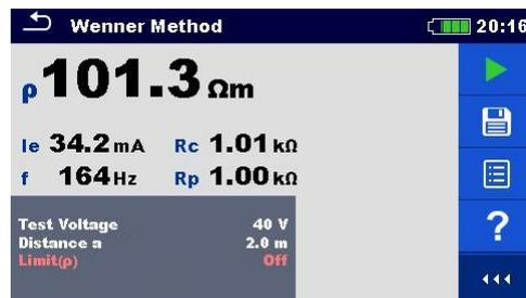
Figura 11.39: Ejemplo de resultado de medición con el método Wenner
