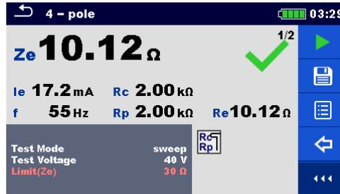
Figura 10.2: Pantalla de resultados de prueba individual. Ejemplo de medición de 4 polos
