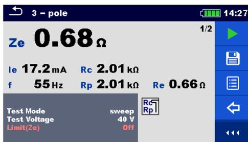
Figura 11.8: Ejemplo de resultado de medición de 3 polos
