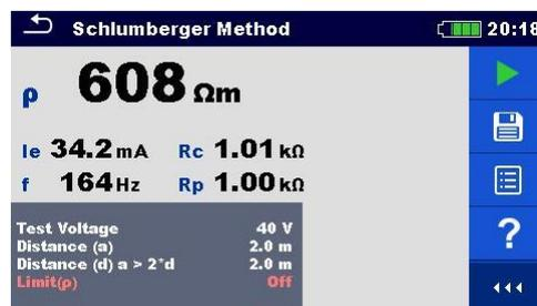
Figura 11.42: Ejemplo de resultado de medición con el método Schlumberger
