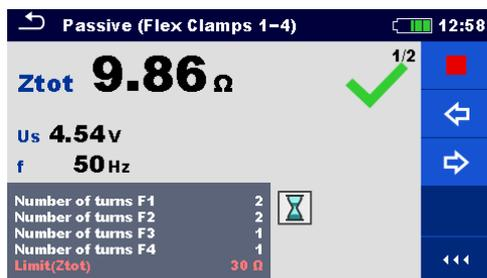
Figura 11.33: Ejemplo de resultado de medición pasiva (pinzas flex)-  $Z_{tot}$
