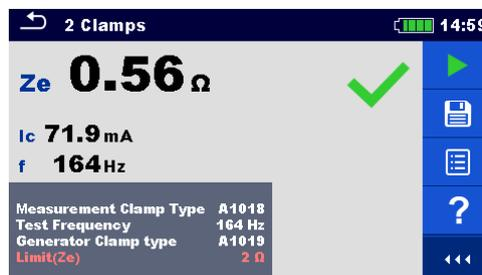
Figura 11.20: Ejemplo de resultado de medición con pinzas 2
