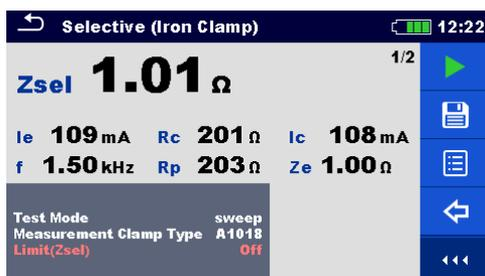
Figura 11.16: Ejemplo de resultado de medición selectiva (pinza de hierro)
