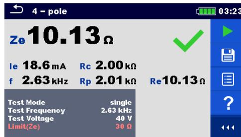
Figura 10.1: Organización de la pantalla de prueba individual. Ejemplo de medición de 4 polos
